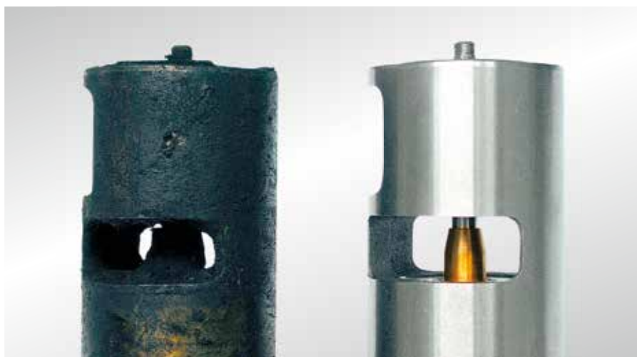
Рис. 38 Клапан системы EGR (дизель) с сильными отложениями и в новом состоянии
