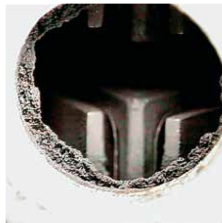
Рис. 31 Отложения на обратном клапане
