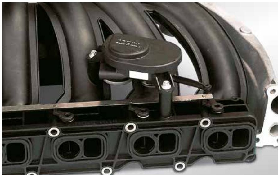
Рис. 41 Впускная труба с перекидными заслонками и EAM-i
