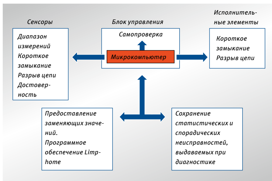
Рис. 1 Самодиагностика электронных систем (бортовая диагностика)
