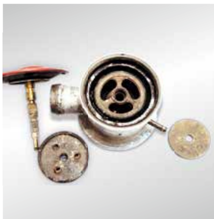
Рис. 30 Отключаемый обратный клапан – повреждения мембраны и головки клапана под действием конденсата
